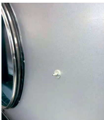
Slika 52: Priključek za cevko za merjenje tlaka v kanalu. Uporabnik mora priloženo cevko namestiti na priključek. Drugi konec cevke se priključi na odvodni kanal. Isti postopek se ponovi na dovodu. Znotraj naprave mora biti cevka nameščena na notranje priključke.
