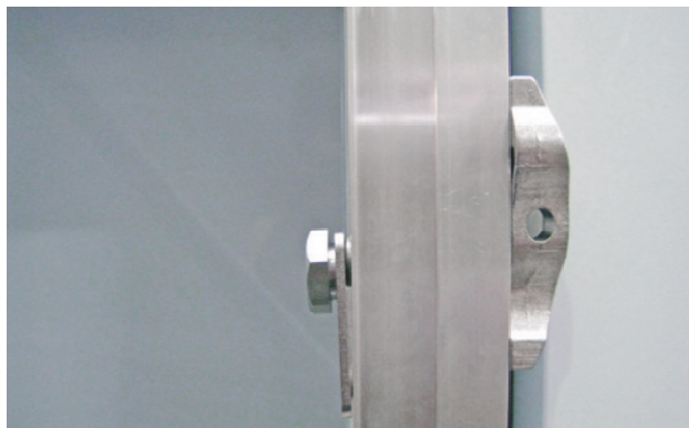
Слика 17: Секције су опремљене стезаљкама са вертикалне и хоризонталне стране, као и са унутрашње и спољашње стране.
