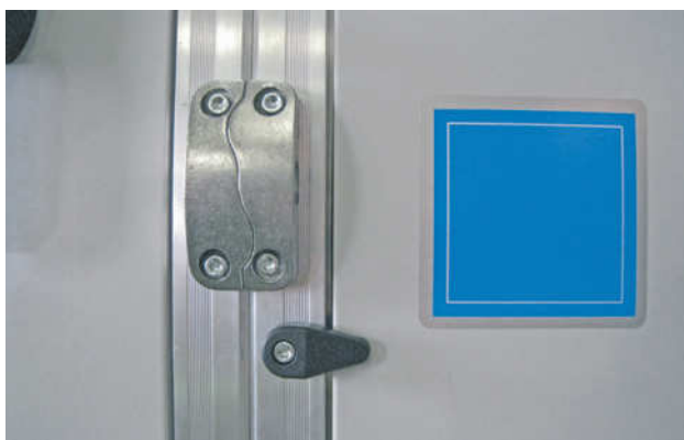
Слика 19: Пошто су секције монтиране заједно, спојити их помоћу екцентричних стезаљки које су постављене на раме секција. Екцентричне стезаљке су постављене и на вертикалним и на хоризонталним странама или на унутрашњој (Слика 20) тј. на спољашњој страни (Слика 19) на раму.
