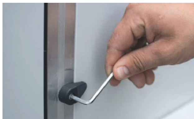
Слика 22: Надпритисна врата и сервисни демонтажни поклопци причвршћени су на кућиште блокаторима. За уклањање / причвршћивање блокатора користити имбус кључ 4 мм.
